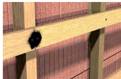
Герметизация головок шурупов
